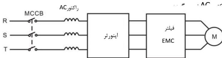
نصب فیلتر EMC در خروجی درایو
